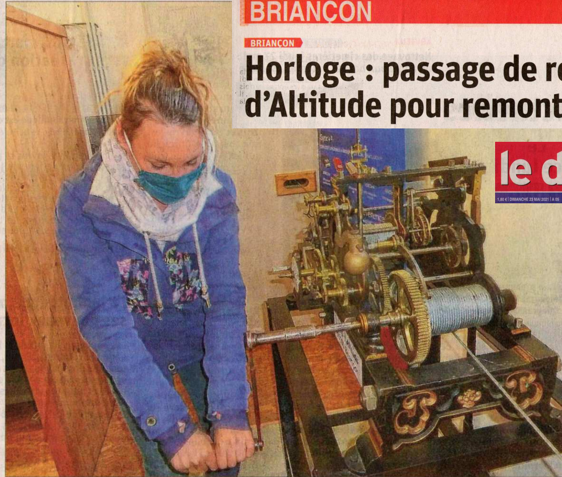
L'horloge du lycée fonctionne si les poids de 35 et 60 kg sont remontés chaque semaine. Désormais, c'est Mathilde Belin, professeure de technologie, qui a en charge cette tâche. Photo DR
