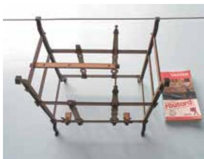
*Fig. 12 - Fabrication de la cage de H1
