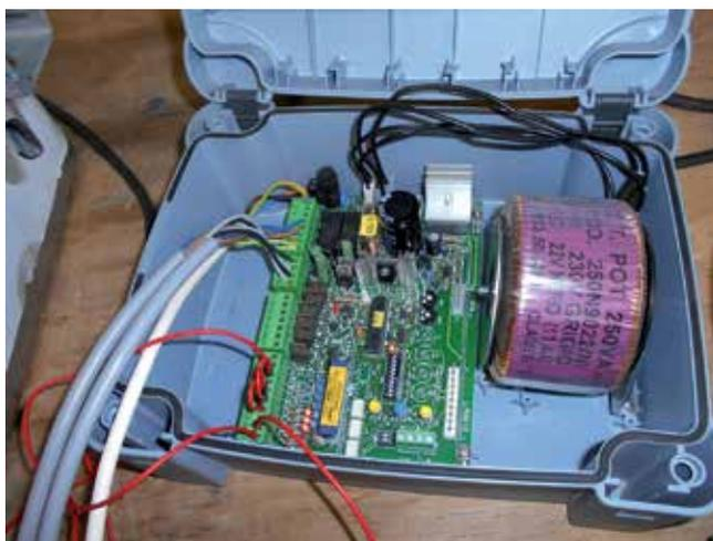
*Fig. 18 - La carte électronique Nice programmable par apprentissage (source : projet HdA).*
