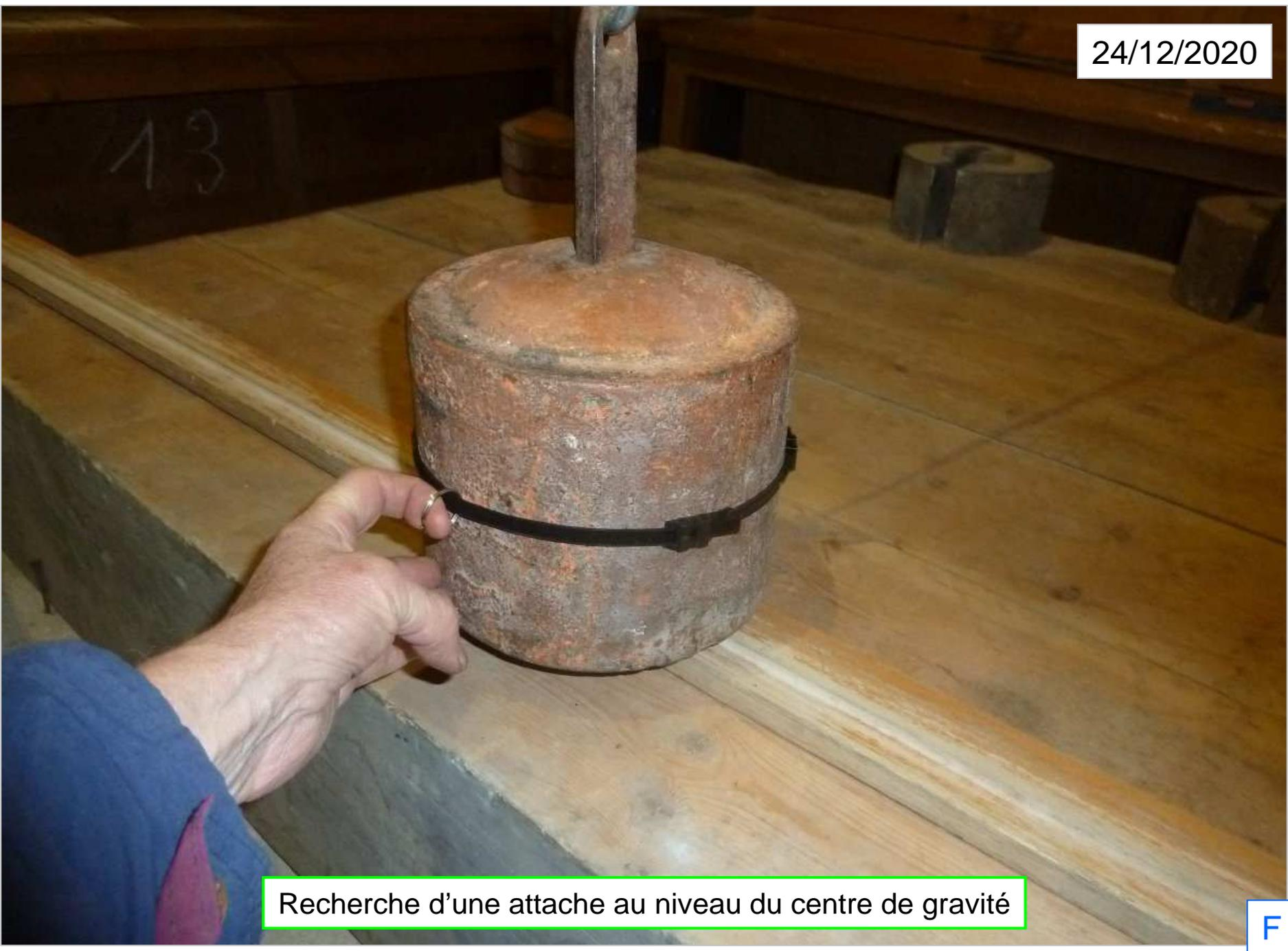
Recherche d'une attache au niveau du centre de gravité
