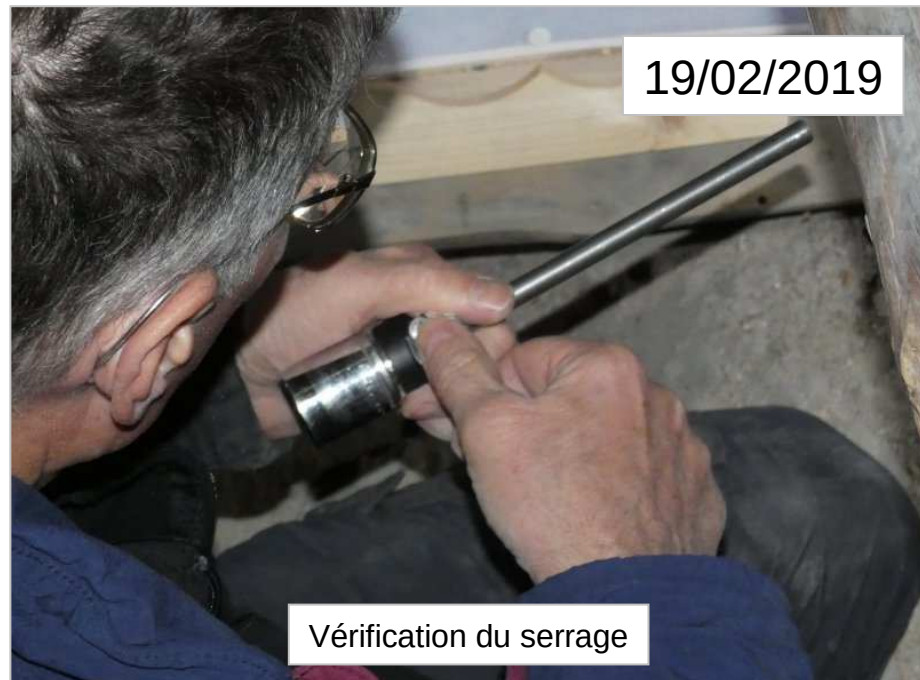
Vérification de la prise de la douille sur l'écrou
