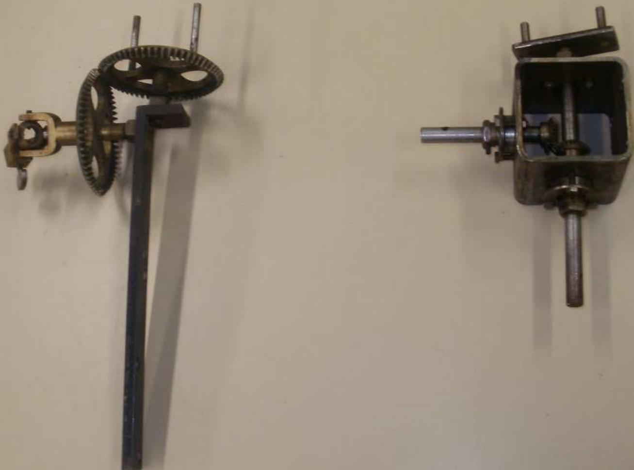
Renvois d'angle Arsène Cretin-l'Ange et Alexis de Kalkreuth
