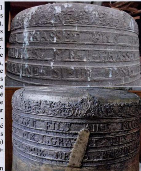
Le fait de laisser apparente la trace de la soudure est peu courante, l'entreprise de restauration reconstituant généralement, par gravure sur le bourrelet de soudure, les lettres et/ou parties de décor altérées par l'élargissement de la fêlure nécessaire pour procéder à la soudure.
