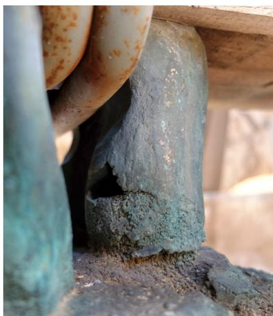
*Photos des anses de la cloche n°2, avec la présence d'un défaut sur l'une des anses doubles à gauche et détail de la maîtresse anse à droite.*
